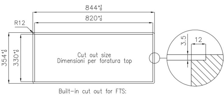
Built—in cut out for FTS: Foratura per installazione FTS: 810 x 330
